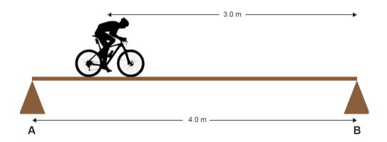
(d) Calculate the values of ALL the forces acting on the bridge.
